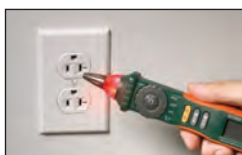
Встроенный бесконтактный детектор напряжения
