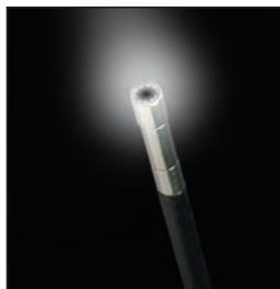
Наконечник камеры со светодиодной подсветкой.
