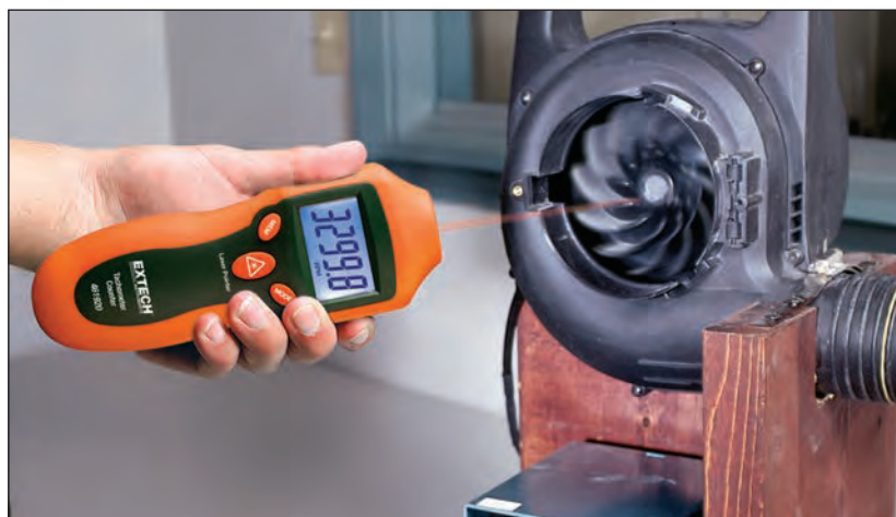
Измерение скорости вращающихся объектов (об/мин.)
