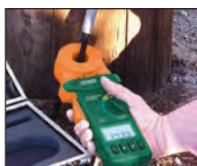
Определяет сопротивление заземления
