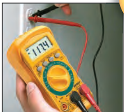
Изображение результатов измерения напряжения переменного тока в электрической розетке
