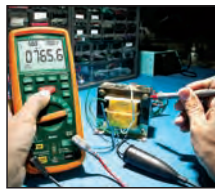
Позволяет измерять сопротивление изоляции обмоток
