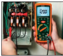
True RMS мультиметр дает точные показатели измерения искаженных сигналов
