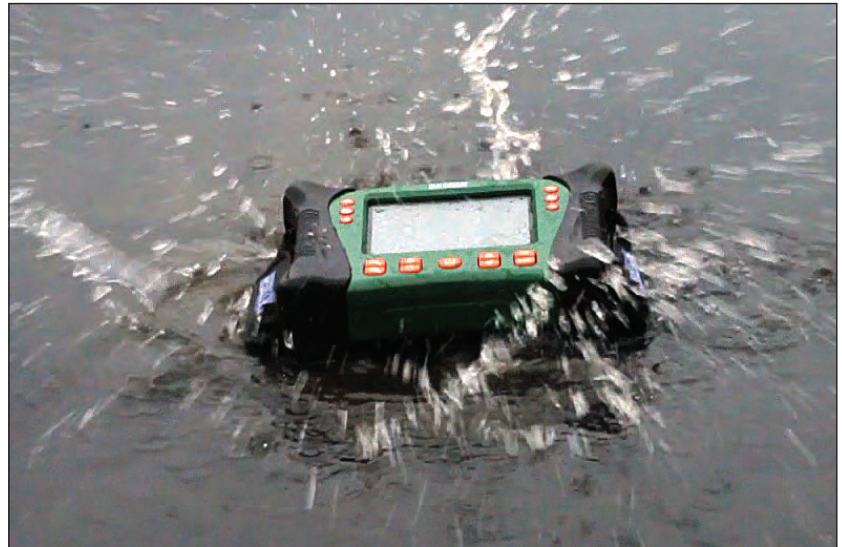
Ударопрочный и водонепроницаемый корпус, разработанный в соответствии с требованиями стандартов IP67
