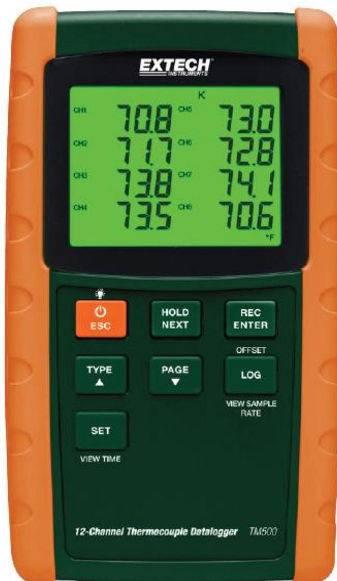
12-канальный регистрирующий термометр для применения в различных сферах измерения с помощью 6 термопарами типа (J, K, E, T, R,S). Дисплей отображает каналы с CH1 по CH8 или с CH9 по CH12, данные могут записываться на карту SD со всех 12 каналов одновременно в формат Excel® для последующего анализа.
