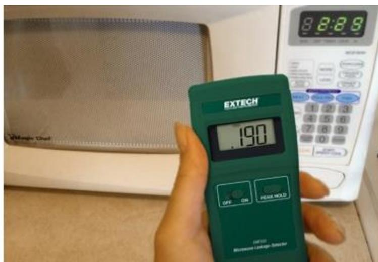
Простой в использовании, компактный детектор СВЧ-утечки предназначен для измерения высокочастотного излучения бытовой техники и микроволновых печей.
